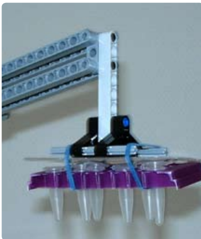
Fig 4 PCR-stället som hänger i robotarmen. Foto: J-O Strömberg.
