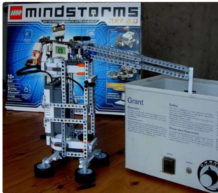
Fig 1. PCR-robot byggd med Lego Mindstorms och ett vattenbad. Foto: J-O Strömberg.
