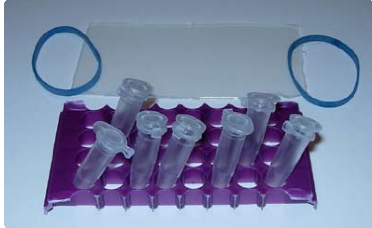
Fig 3. PCR-stället med eppendorfrör. Bilden visar delarna som PCR-stället byggs upp av. Foto: J-O Strömberg.
